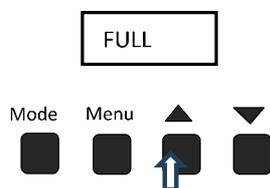
Alle LEDs werden auf der höchsten Intensität angeschaltet.
